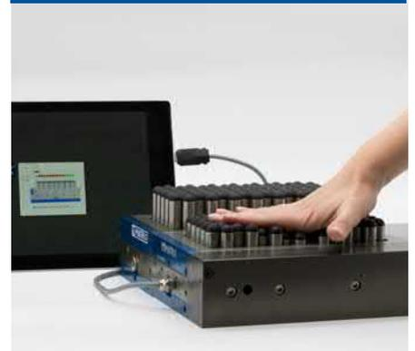
この自動クランプシステムは電気でロックします。ワークピースが所定の位置に配置された後、ピン束は電動アクチュエータによってロックされます。電動AGVなどで使用可能です。
